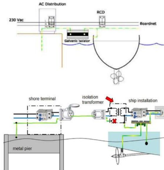
*Raccordement des navires (avec ou sans isolateur) à un quai ou à un ponton.*
